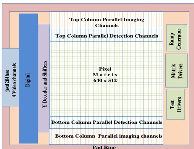
Fig. 3. ROIC Floor plan
